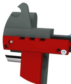
**Servicio optimizado:** Los perfiles de deslizamiento de alta resistencia al desgaste pueden ser cambiados rápida y fácilmente en el lugar de trabajo sin usar herramientas especiales.
