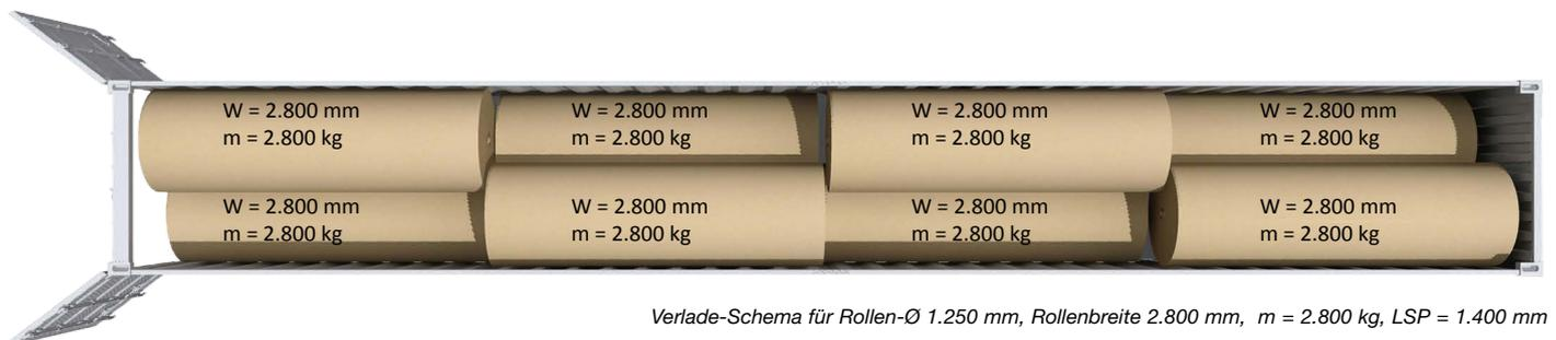
Diese Art der Verladung von Papierrollen in Containern stellt besondere Anforderungen an Stapler und an Anbaugerät. Denn die Last von bis zu 4 Tonnen wird bei einem Lastschwerpunkt von 1.400 mm aufgenommen, in den Container transportiert und mit Seitenschub bis an die Containerwand verfahren. Die einzige Möglichkeit, die Papierrolle stirnseitig aufzunehmen, ist eine Papphülse mit einem Durchmesser von 100 mm, auf die die Rolle aufgewickelt ist.
