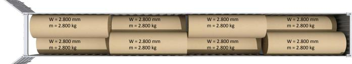
Loading pattern for rolls- $\emptyset$  1.250 mm, roll length 2.800 mm, m = 2.800 kg, l.l.c. = 1.400 mm
