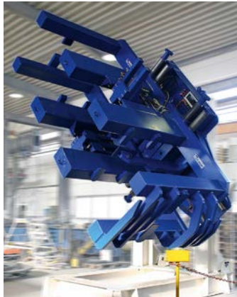
25T251W/099 - retourneur de plaques de tôles
