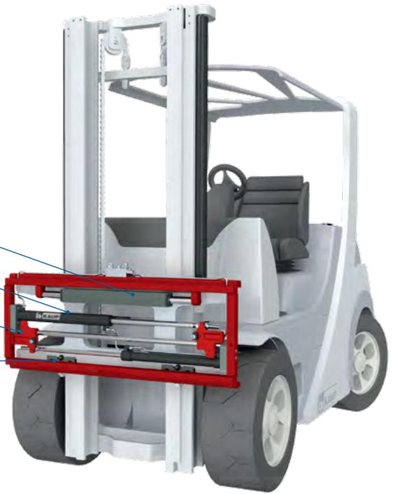
**QUICKSEAL**-Cilindro del desplazamiento lateral para cambiar rápidamente los juegos de juntas sin herramientas
