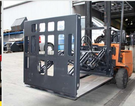
**Push-Pull con desplazamiento lateral y recuperador de hoja T146S**
