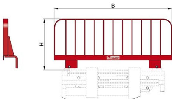
**Dosseret de charge T479** Pour modèles KAUP de la série T160, T410Z, T411, T411Z, T411ZR, T411D, T412, T413, T414, T415, T406, T466
