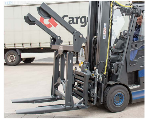
3 Rasterpositionen zur manuellen Einstellung der Druckarme für Palettenrahmenhöhen von 800, 1.200 und 1.600 mm
