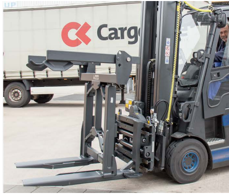
3 Rasterpositionen zur manuellen Einstellung der Druckarme für Palettenrahmenhöhen von 800, 1.200 und 1.600 mm
