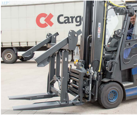
3 Rasterpositionen zur manuellen Einstellung der Druckarme für Palettenrahmenhöhen von 800, 1.200 und 1.600 mm
