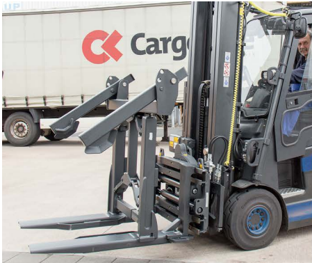
3 posiciones de ajuste manual del marco estabilizador para alturas de palets de 800, 1.200, 1.600.mm
