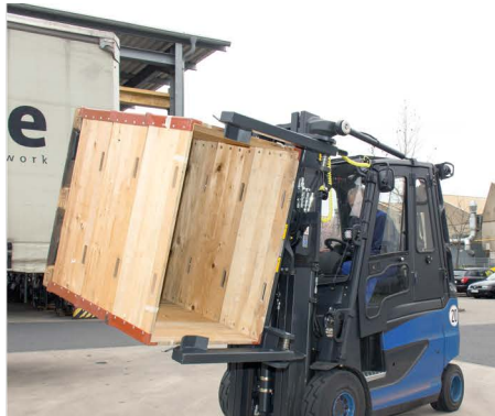
Perfecta para el vaciado de cajas tipo Europalét con bastidor
