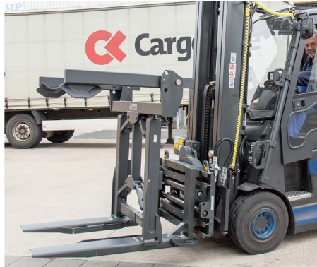
3 posiciones de ajuste manual del marco estabilizador para alturas de palets de 800, 1.200, 1.600.mm
